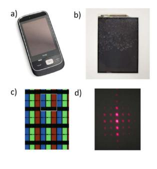
Del análisis de los patrones de difracción obtenidos con luz monocromática, se determina la estructura espacial de los componentes. Las medidas realizadas sobre los patrones se comparan con las obtenidas con un microscopio óptico. Las discrepancias en todos los casos resultaron menores del 5 %.
